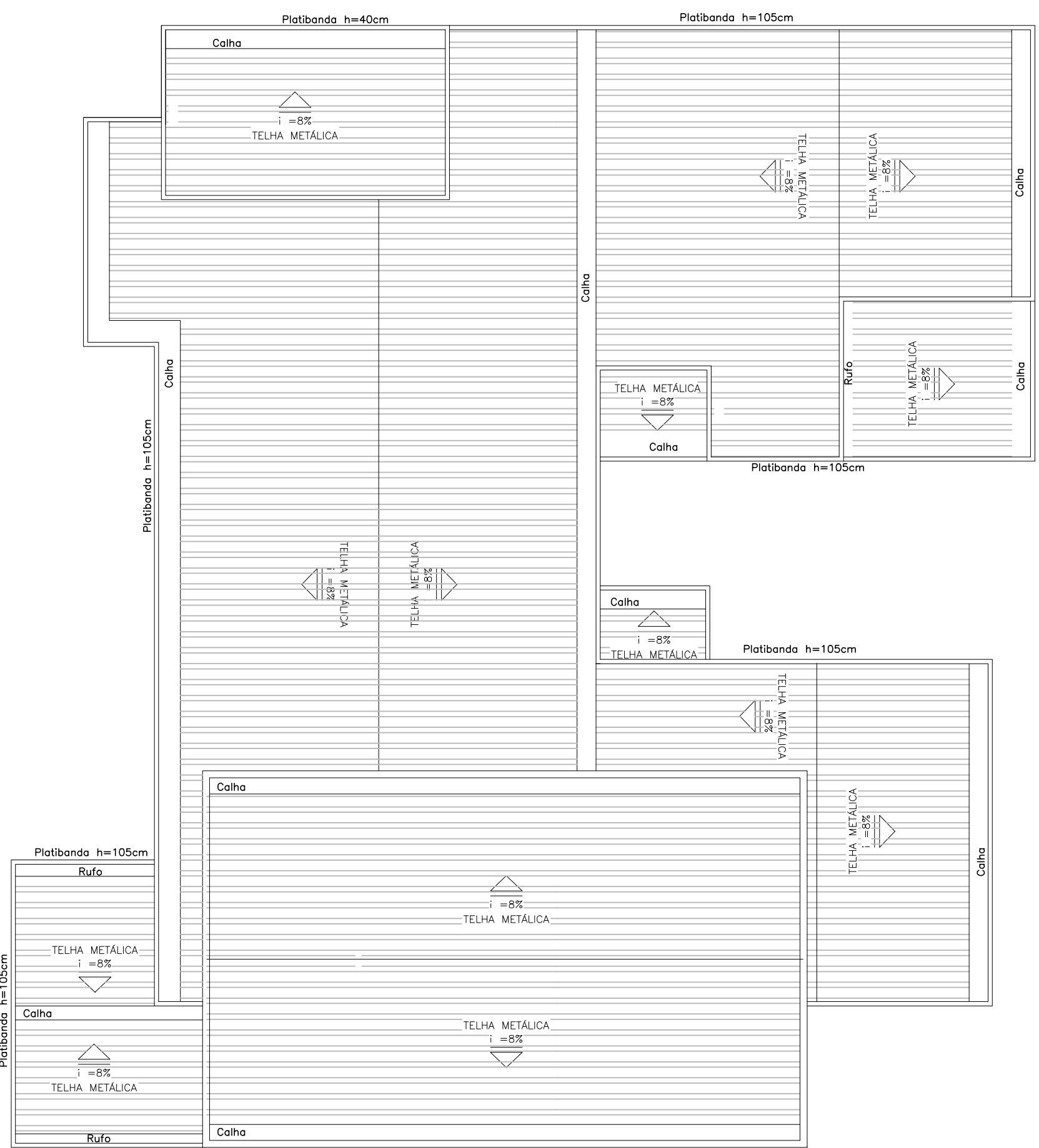
PLANTA DE COBERTURA PROJETO DE IMPERMEABILIZAÇÃO ESCALA.....1/100
