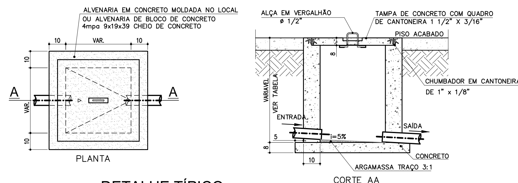
DETALHE TÍPICO CAIXA DE INSPEÇÃO REDE ESGOTO (C) SEM ESCALA
